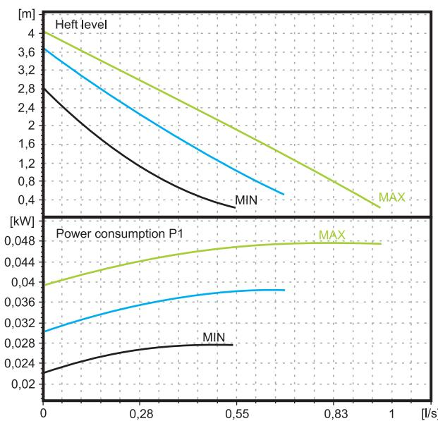
Statie de pompare, cu o cale, pentru instalatii solare. Utilizata pentru circulatia fluidului solar in instalatii pentru preparare apa calda menajera si aport la incalzire.
